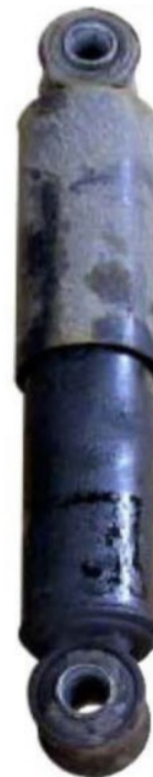
Kuva 2: öljyä vuotava iskunvaimennin
